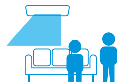
Flux d'air dirigé à l'écart des occupants
