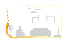
En mode chauffage, les volets dirigent l'air vers le bas (débit d'air vertical).
